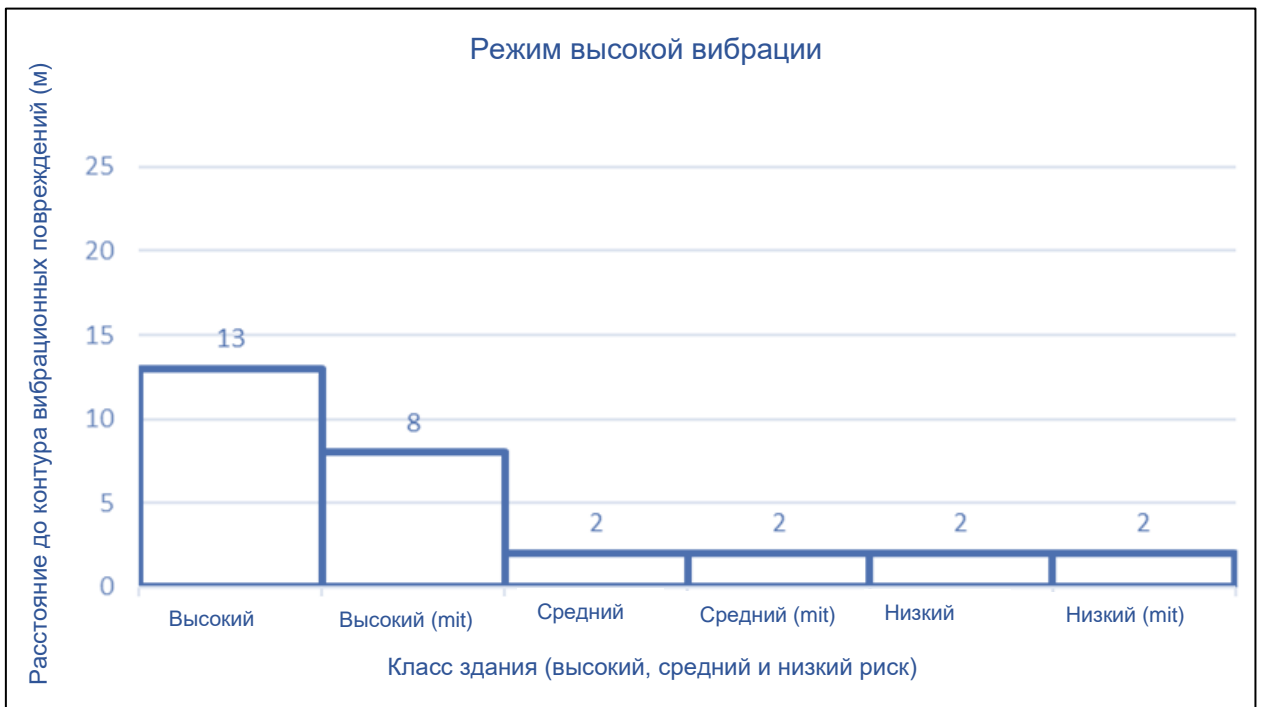
Рис. 178: Прогнозируемое расстояние до контура виброповреждений (мелких структурных) для зданий с высоким, средним и низким риском повреждений при уровне прогнозирования TRL 66% для виброкатка, работающего в режиме высокой вибрации.
