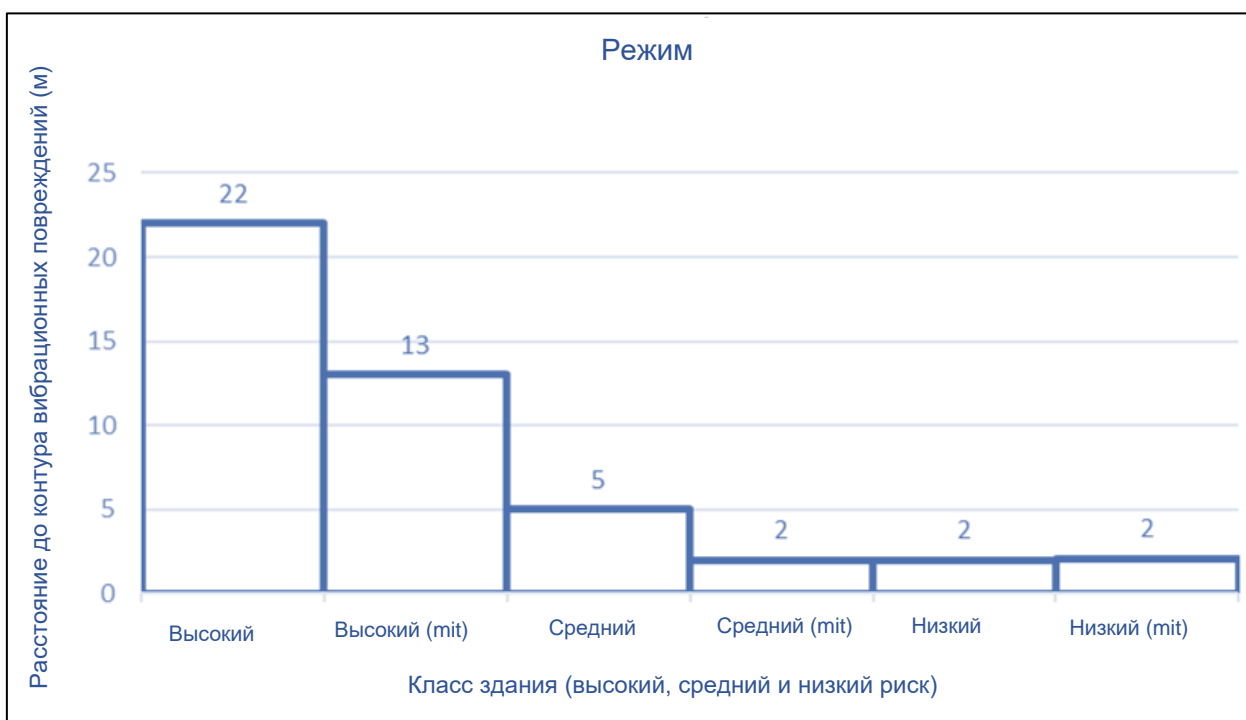
Рис. 176: Прогнозируемое расстояние до контура виброповреждения (косметическое) для зданий с высоким, средним и низким риском повреждения при уровне прогнозирования TRL 66% для виброкатка, работающего в режиме высокой вибрации.
