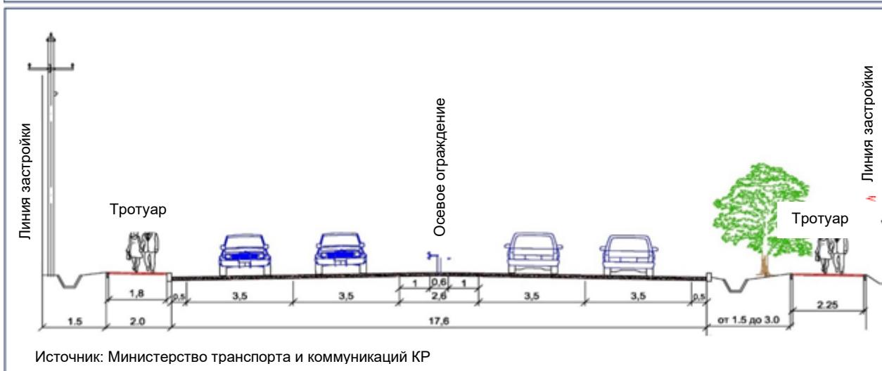
Рис. 8: Типовой поперечный профиль дороги в населенных пунктах.
