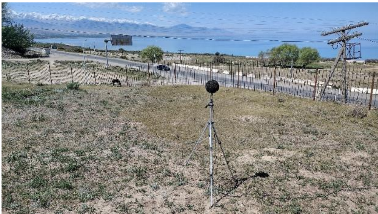
Рис. 45– Шумомер, используемый для измерения (в чистом поле) уровня окружающего шума вблизи дороги в селе Ак-Терек
