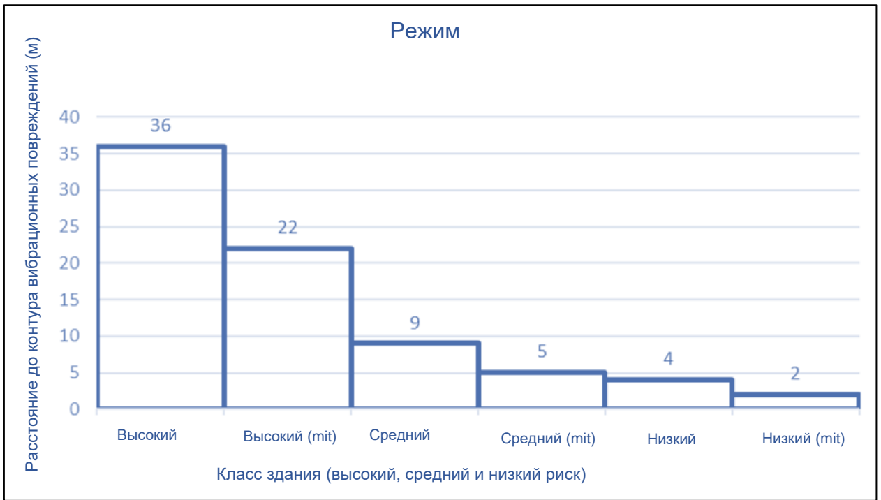
Рис. 177: Прогнозируемое расстояние до контура виброповреждения (косметическое) для зданий с высоким, средним и низким риском повреждения при уровне прогнозирования TRL 95% для виброкатка, работающего в режиме высокой вибрации.
