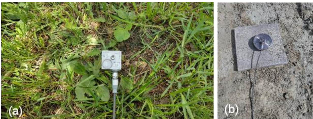
Рис. 46: Оборудование для мониторинга вибрации, используемое при измерении вибрации
